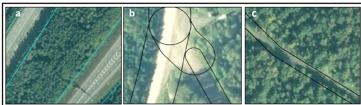
Figure 3. Exemple de résultats de surfaces de routes obtenues depuis les largeurs totales moyennes établies pour a) les autoroutes, b) les grands chemins forestiers et c) les petits chemins forestiers.
